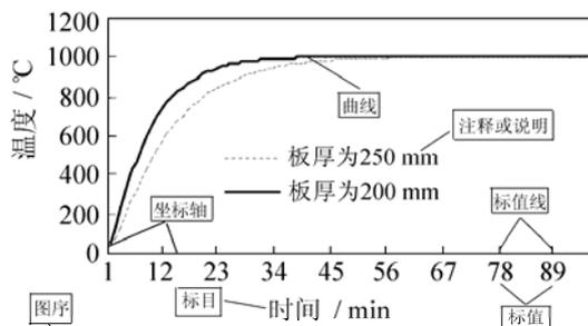
图1 不同厚度板的中心温度随时间的变化
